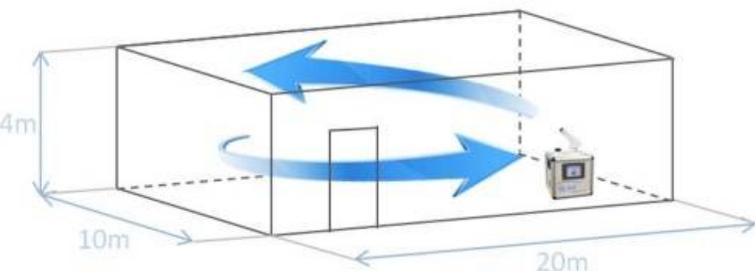
Nel caso di ambienti di grande volumetria è possibile abbinare alla macchina generatrice dell'aerosol anche un ventilatore per favorire la dispersione del sanificante in ambiente.
